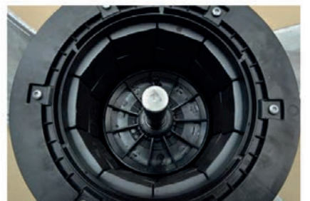
Ocelový rotor s umělohmotným chladičím kolem
