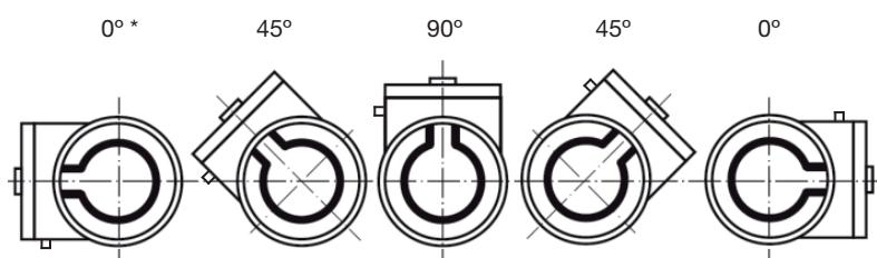
\* tato poloha není optimální z hlediska proudění vzduchu chladičem triakového regulátoru, doporučujeme použít pouze v krajních případech
