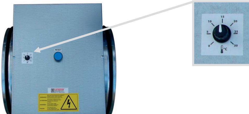
Ovladačem teploty na ohřívači lze nastavit žádanou teplotu při provozu s teplotním čidlem (zapojení 1 a 3 bez doplněného zapojení 6 – viz dále). Předpokladem je nezapojená svorka 3 a zkratovaná propojka Interní/externí nastavení teploty.
