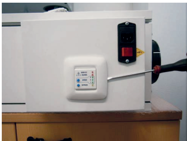
1. Sejměte rámeček ovládacího panelu
