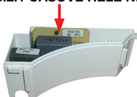
obr. 4 – instalace časového relé
