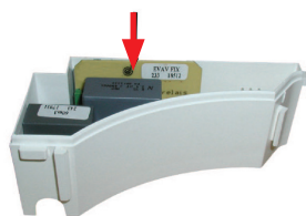
obr. 4 – instalace časového relé
