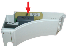
obr. 4 – instalace časového relé
